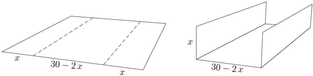
L'aire d'une coupe transversale de la gouttière vaut :
