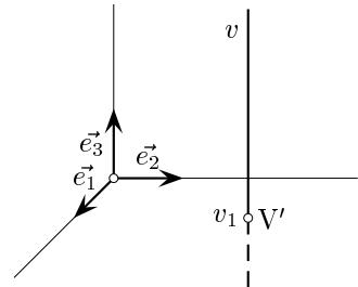
Une droite **de bout**  $b$  est perpendiculaire à  $\pi_2$ .  $b$  et  $b_1$  sont parallèles à  $Ox$ . Une droite de bout est à la fois horizontale et de profil. Ainsi  $b$  est en vraie grandeur selon l'unité de  $Ox$ .
