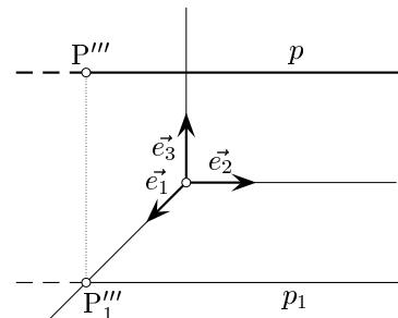
La représentation d'une droite  $d$  **parallèle au noyau** est telle que  $d$  se réduit à un point confondu avec ses trois traces et que  $d_1$  est parallèle à  $Oz$ .
